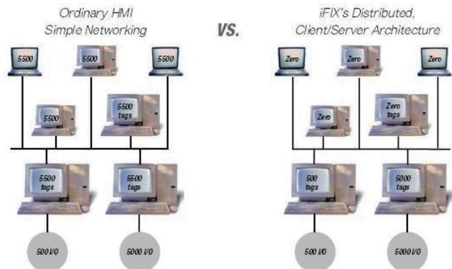
不同於普通一般 HMI/SCADA 套裝軟體設計的簡易系統，若增加工作站時，需要在所有的節點上添加新的節點資訊，而且要在每一節點上複製所有的 Tag 製程資料庫。使用 iFIX 的分散式、Client/Server 架構，添加新的工作站十分簡單，只需將新的伺服器連接到網路上即可。添加或更改資料點時只需在新節點進行更改，系統就會自動地更新整個系統。每一節點的資料對整個系統的用戶都是可監控的。在系統添加客戶和伺服器簡單明瞭、無需更改系統中其他節點設置。
